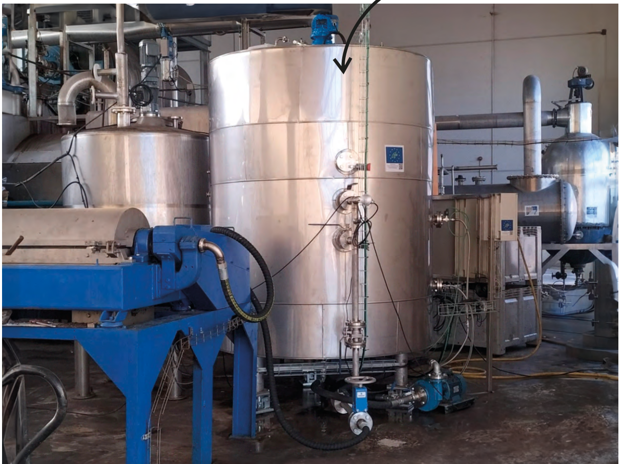
Unidad 1 de hidrólisis enzimática de 5\text{ m}^3 .
